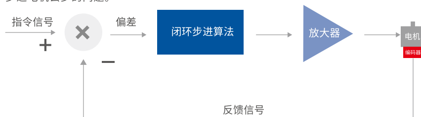
CL3-EC闭环步进控制系统图
