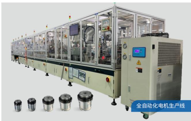
全自动化电机生产线
