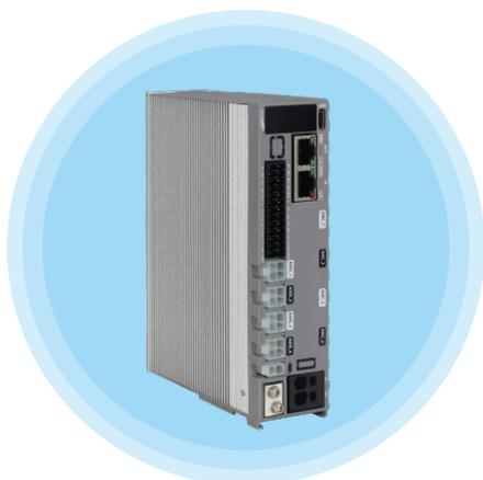
4DM3-EC系列是雷赛在高性能数字步进驱动器基础上增加了总线通讯功能的四合一驱动产品。总线通讯采用EtherCAT总线通讯接口,基于EtherCAT从站技术,符合CiA402标准,总线传输速率,可100Mb/s,且支持CSP、PP、PV、HM控制模式,具有省空间、省时间、省成本等优势,可实现步进系统的实时控制与数据传输。对于多轴控制网络,采用高效、稳定、成熟的EtherCAT工业总线方案能够给客户带来空间、成本及系统复杂度的显著优化。
