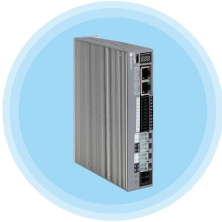
4DM3C-EC系列是雷赛推出的一款经济型EtherCAT总线步进四合一驱动产品,其采用EtherCAT总线通讯接口,符合CiA402标准,总线传输速率可100Mb/s,支持CSP、CSV、PP、PV、HM控制模式,可高效实现四个轴独立控制,具有优、易、省等多重优势,相对于标准单轴EtherCAT产品具有超高的性价比。
