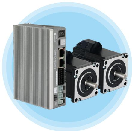
2CL3-EC系列是雷赛在高性能数字步进驱动器基础上增加了总线通讯功能的二合一驱动产品。总线通讯采用EtherCAT总线通讯接口,基于EtherCAT从站技术,符合CiA402标准,总线传输速率可达100Mb/s,且支持CSP、PP、PV、HM控制模式,具有省空间、省时间、省成本等优势,采用闭环控制,高速运行不丢步。可实现步进系统的实时控制与数据传输。对于多轴控制网络,采用高效、稳定、成熟的EtherCAT工业总线方案能够给客户带来空间、成本及系统复杂度的显著优化。
