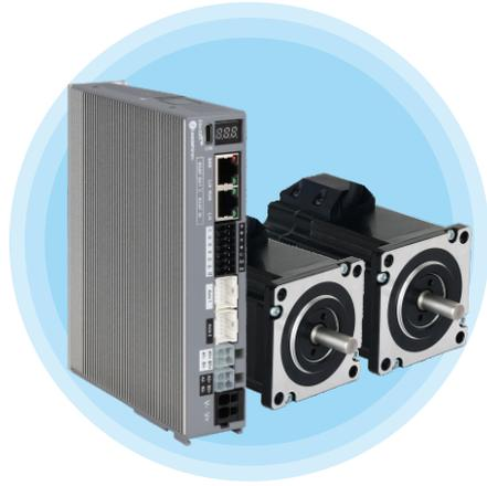
2CL3-ECS系列是雷赛在高性能数字步进驱动器基础上增加了总线通讯功能的二合一闭环驱动产品。驱动器支持17位多圈绝对值编码器,相比增量式编码器可实现更高精度的定位控制,同时还具有掉电位置记忆保持功能,回原可无需外部传感器。基于EtherCAT从站技术,符合CiA402标准,总线传输速率可达100Mb/s,且支持CSP、CSV、PP、PV、HM控制模式,具有省空间、省时间、省成本等优势,实现步进系统的实时控制与数据传输。
