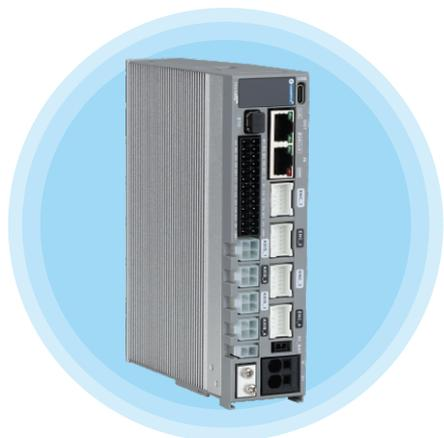
4CL3-ECS系列是雷赛在高性能数字步进驱动器基础上增加了总线通讯功能的四合一闭环驱动产品。驱动器支持STO功能,支持17位多圈绝对值编码器,相比增量式编码器可实现更高精度的定位控制,同时还具有掉电位置记忆保持功能,回原可无需外部传感器。基于EtherCAT从站技术,符合CiA402标准,总线传输速率可达100Mb/s,且支持CSP、CSV、PP、PV、HM控制模式,具有省空间、省时间、省成本等优势,实现步进系统的实时控制与数据传输。
