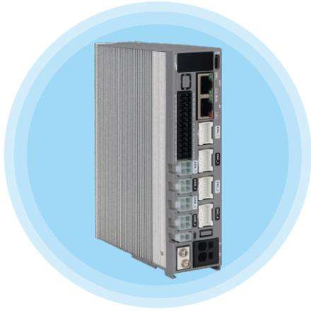
4CL3-EC系列是雷赛在高性能数字步进驱动器基础上增加了总线通讯功能的四合一闭环驱动产品。总线通讯采用EtherCAT总线通讯接口,基于EtherCAT从站技术,符合CiA402标准,总线传输速率,可100Mb/s,且支持CSP、CSV、PP、PV、HM控制模式,具有优、易、省等多重优势,可实现步进系统的实时控制与数据传输。对于多轴控制网络,采用高效、稳定、成熟的EtherCAT工业总线方案能够给客户带来空间、成本及系统复杂度的显著优化。
