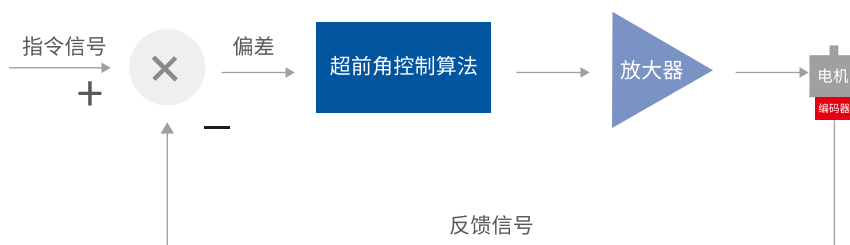
CL1闭环步进控制系统图
