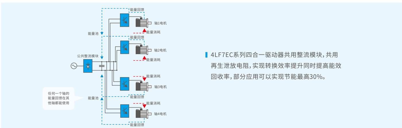
4LF7EC系列四合一驱动器共用整流模块，共用再生泄放电阻，实现转换效率提升同时提高能效回收率，部分应用可以实现节能最高30%。
