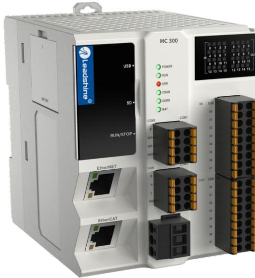
MC300系列基本型PLC,是雷赛具有自主知识产权的中型PLC,主要面向电子行业、3C加工、新能源光伏、锂电行业设备、物流行业设备、包装行业设备等。MC300系列支持EtherCAT总线,支持最大32轴总线控制,同时支持点位运动,同步运动,IO扩展功能等,能够很好的适配行业需求。
