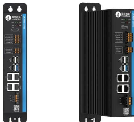
LC2000 系列智能产线控制器是雷赛面向先进制造业推出的 EtherCAT 总线型运动控制器, 基于 X86+CODESYS 运动控制平台。采用全金属机身, 提供丰富的网络接口来满足各种项目的扩展需求, 搭载 Celeron CPU, 提供卓越的运算能力, 适用于128轴以内的整线设备控制。广泛应用于光伏、锂电、3C、包装、物流等行业。
