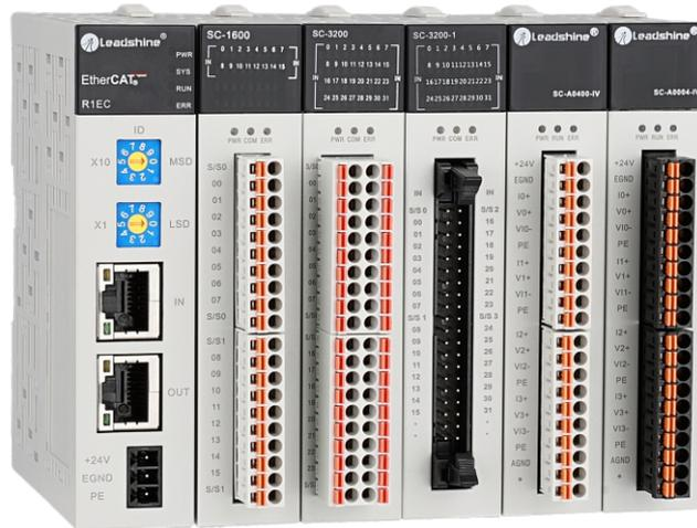
R1系列是雷赛智能经济型远程I/O产品，包括R1系列经济型耦合器和远程I/O产品。其中R1系列经济型总线耦合器最大可支持16个右扩展I/O；远程I/O包括数字量输入/输出模块，模拟量输入/输出模块等。主要应用于3C智能制造、光伏锂电新能源、物流等行业。
