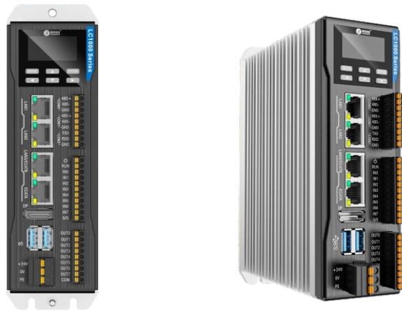
LC1000系列智能产线控制器,小体积,高性能,强运控,轻松实现高达48轴及32000点IO的设备控制,最小总线周期可达250 $\mu$ s,内置UPS实现5M掉电保护功能,低功率无风扇设计, LCD提升调试维护的易用性,高速8DI+8DO完成飞拍飞剪及锁存功能,易用的编程软件,多种标准的通信接口和通信协议,丰富的行业工艺算法,帮助您缩短设备开发周期,高效交付生产,实现工厂精益制造。
