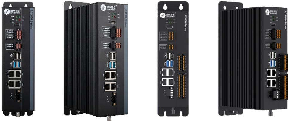
LC5000系列智能产线控制器分为：标准版LC5000和高速IO版LC5000IO。LC5000IO自带高速IO、编码器接口，用于高速比较飞拍、高速锁存、手轮控制。
