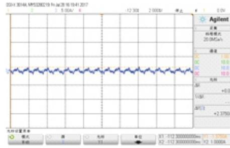
图7 57CM23电机在900rpm时的绕组电流波形
