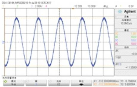
图6 57CM23电机在60rpm时的绕组电流波形
