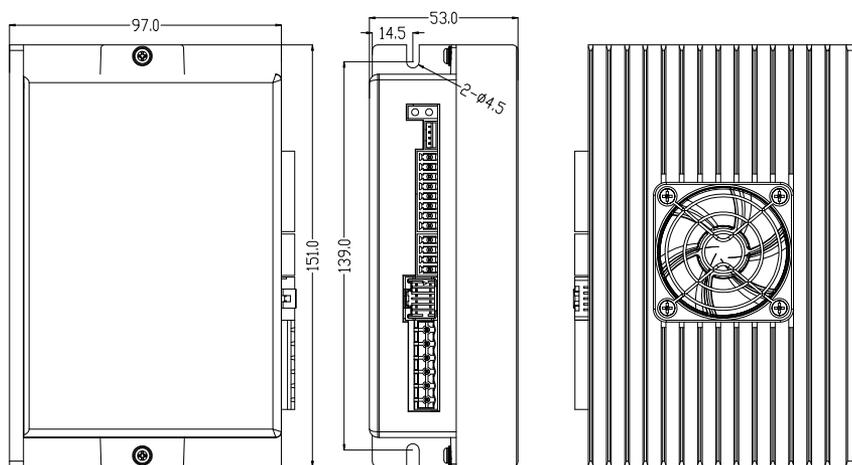
CL2B-RS808AC安装尺寸图
