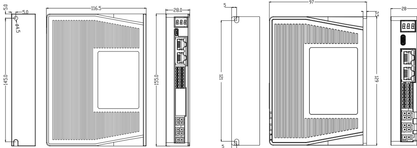
2DM3-EC522/556/870安装尺寸图
