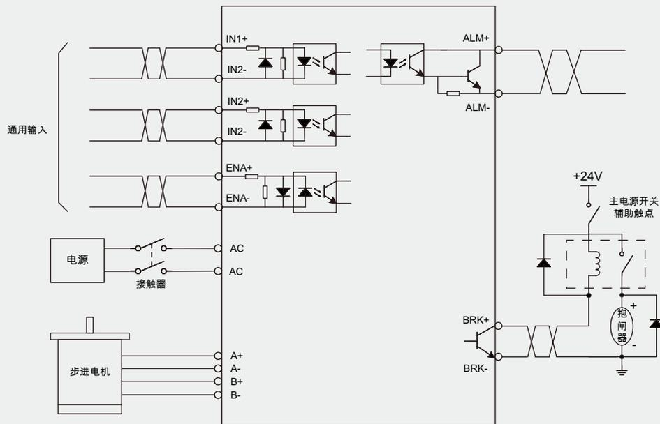
DM1-IO860C电气接线图
