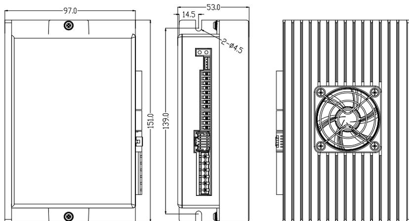
DM2B-RS882AC安装尺寸图
