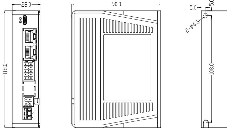
DM3B-EC522/542/556/570安装尺寸图
