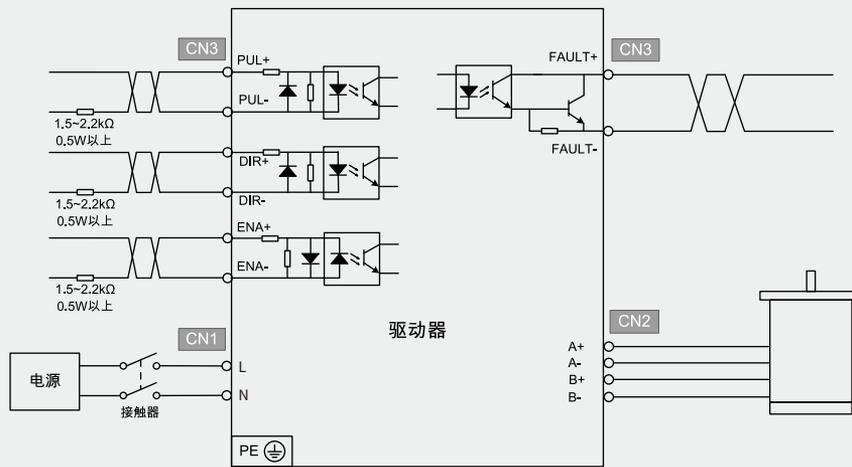
DM2282电气接线图
