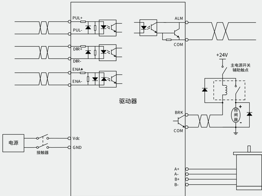
DM542/DM556/DM870电气接线图
