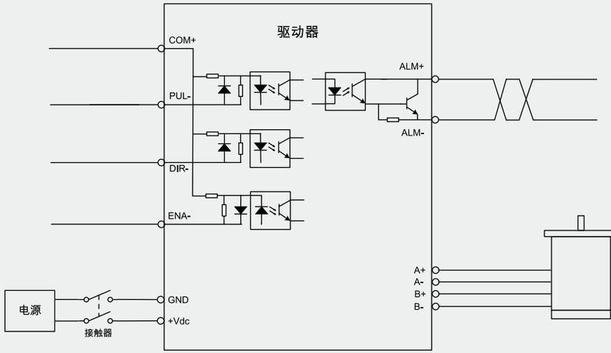
DM422电气接线图
