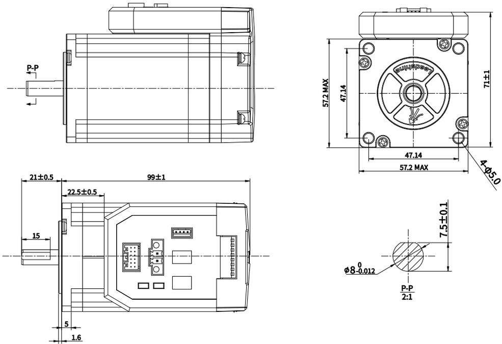
iCL系列是雷赛智能全新打造的智能一体式闭环步进电机产品,该产品安装尺寸兼容现有的42/57/60机座的电机,特别适用于对安装空间有更高要求的场合,此外也能进一步降低产品的应用成本和购买成本,从而为客户带来更大的价值。
