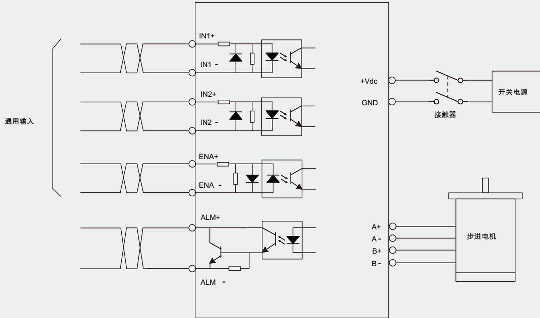
DM1-IO442C、DM1-IO542C、DM1-IO556C电气接线图
