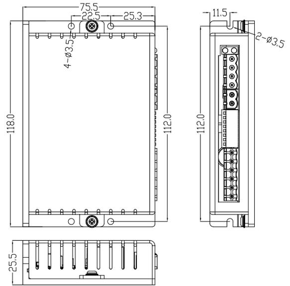
DM1-IO542C、DM1-IO556C安装尺寸图
